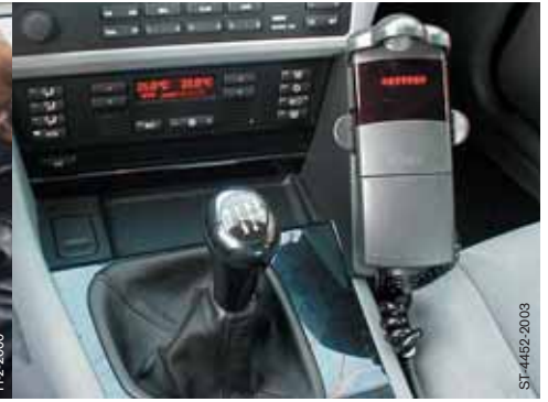
Bild 12: Dräger Interlock, eine atemalkoholgesteuerte Wegfahrsperrung
