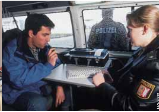
Bild 11: Alcotest 7110 Evidential mit infrarot-optischem und elektrochemischem Sensor im Jahr 1998
