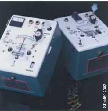
Bild 6: Dräger Breathalyzer mit nasschemischem Messverfahren
